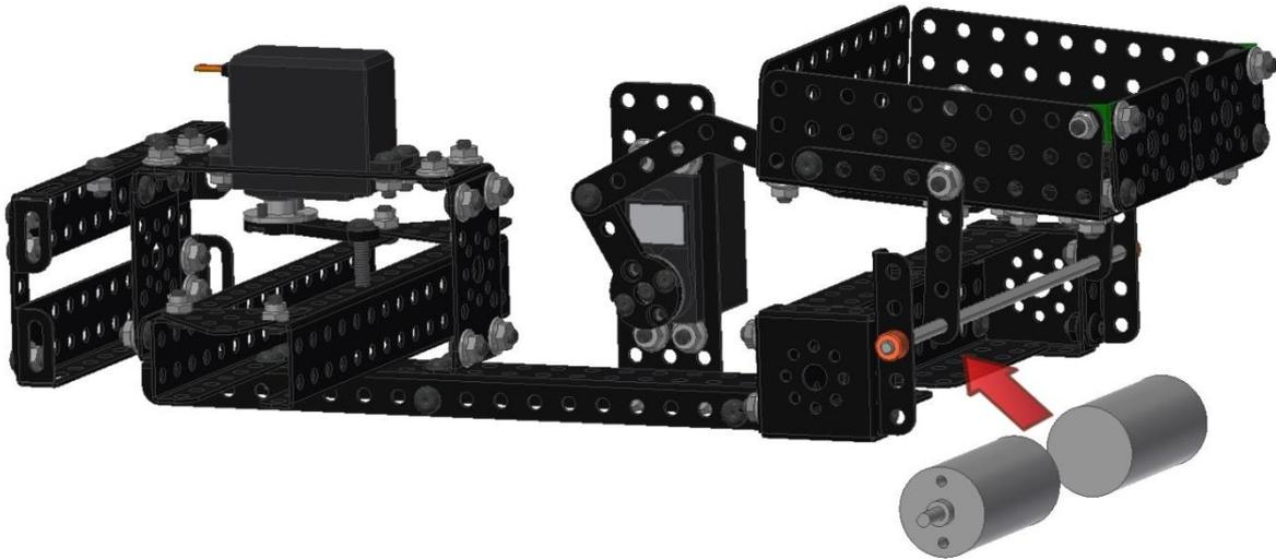
Закрепите моторы на адаптерах винтами М4
