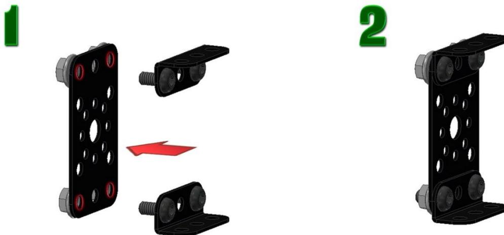
Возьмите две заготовки и закрепите их на основании по примеру
