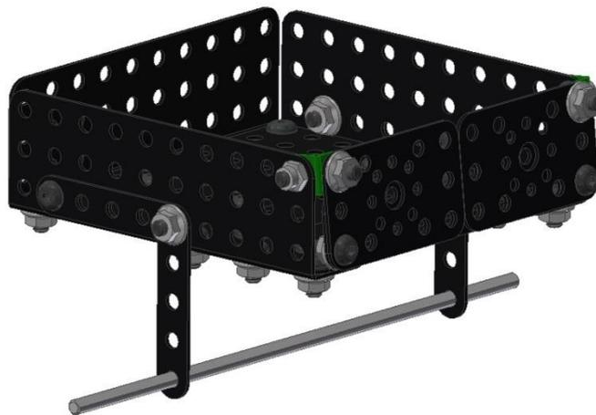
Соедините кузов с основанием с помощью оси. Закрепите ось на основании с помощью двух стопорных колец M4
