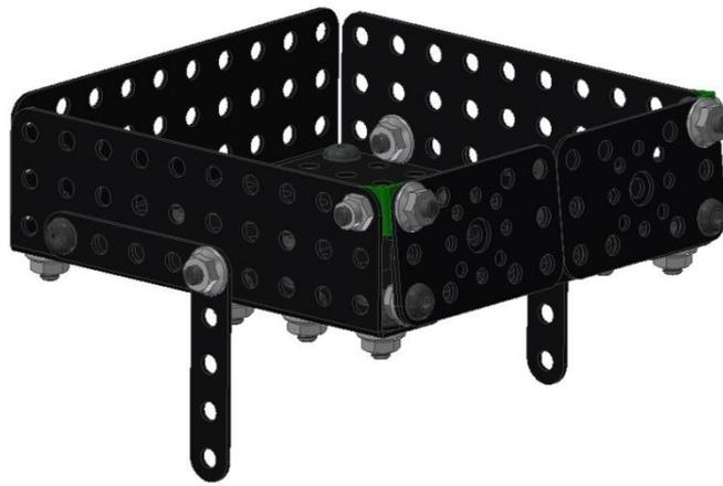
Возьмите ось длиной 165 мм и вденьте ее сквозь два плоских угла по примеру
